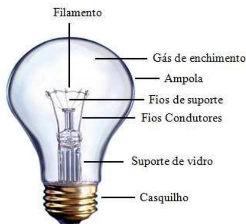
Figura 3.2 – Constituição de uma lâmpada de incandescência [30]
