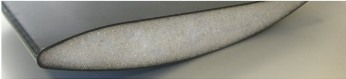
Figura 14 - Exemplo de espuma PMI Rohacell [rohacell.com, 2014]
