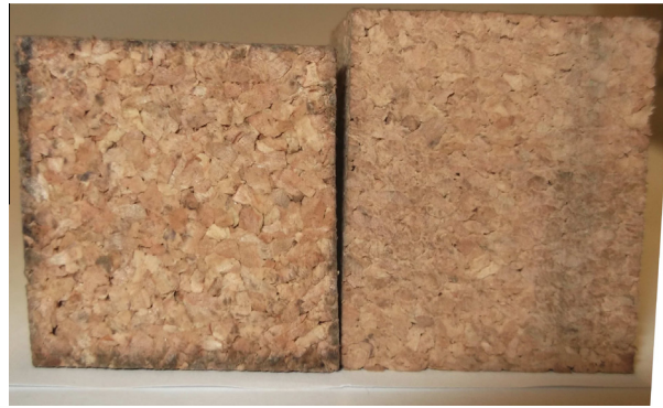
Figura 7 - Provetes de aglomerado de cortiça depois e antes dos ensaios [Fernandes et al , 2014]
