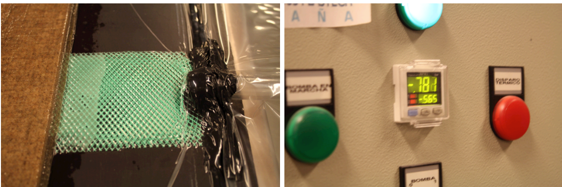
Figura 38 - Pormenor da rede espaçadora e da pressão de vácuo
