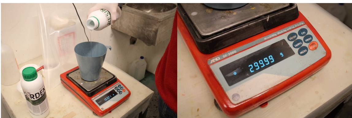
Figura 31 - Pesagem da bioresina epóxi
