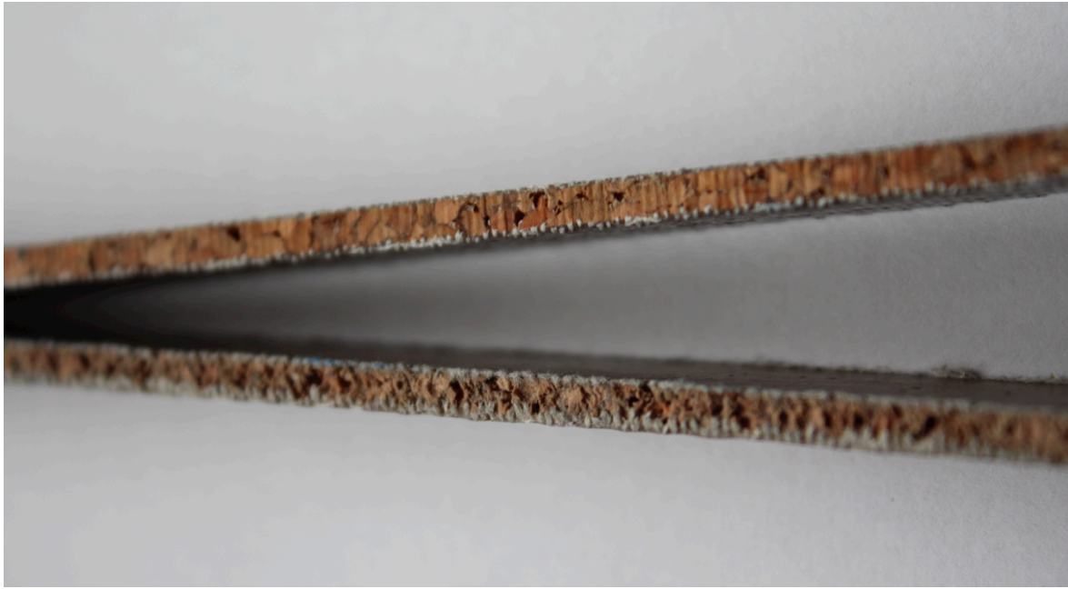
Figura 40 - Comparativo de corte: em cima jato de água e em baixo serra de fita
