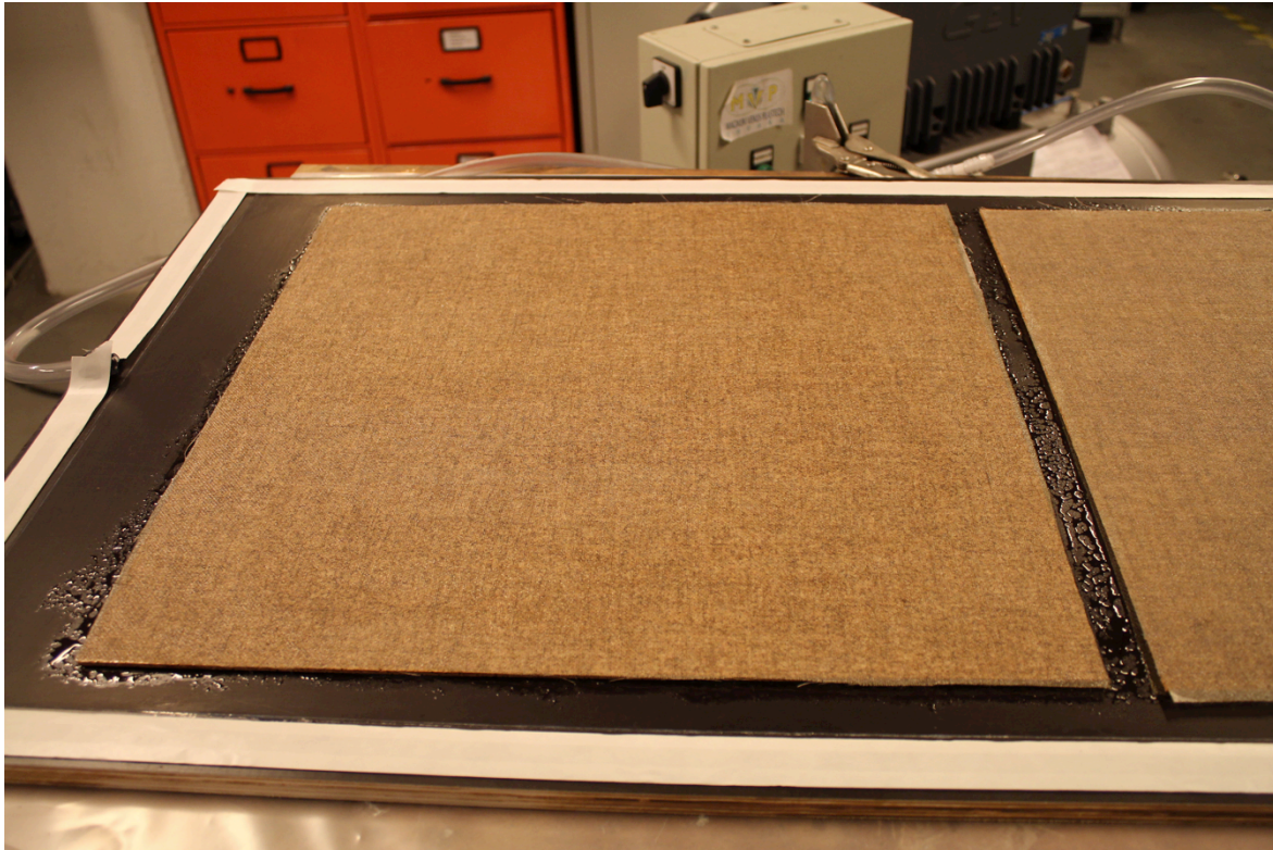
Figura 36 - Segunda face da sandwich já impregnada
