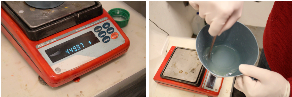
Figura 32 - Pesagem do endurecedor e mistura dos componentes
