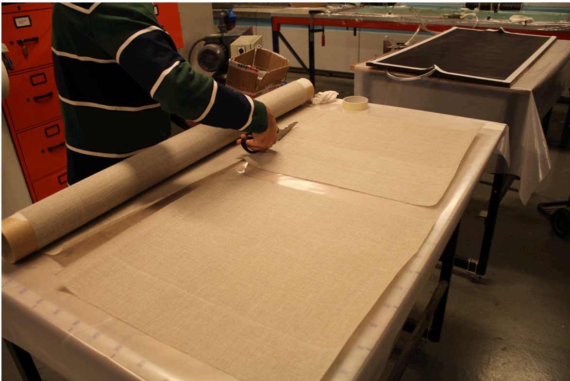
Figura 30 - Corte das mantas de fibra de linho para laminagem
