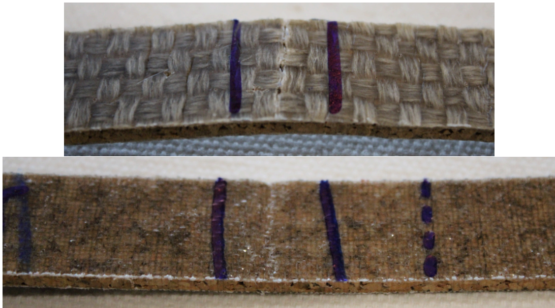
Figura 53 - Falha da face (em cima) e indentação (em baixo)
