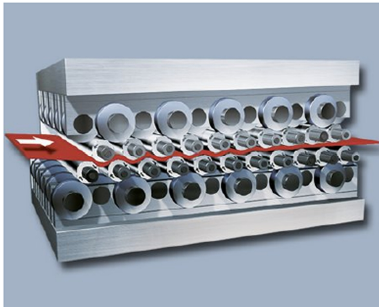
Fig. 10 Nivelador com rolos de suporte
