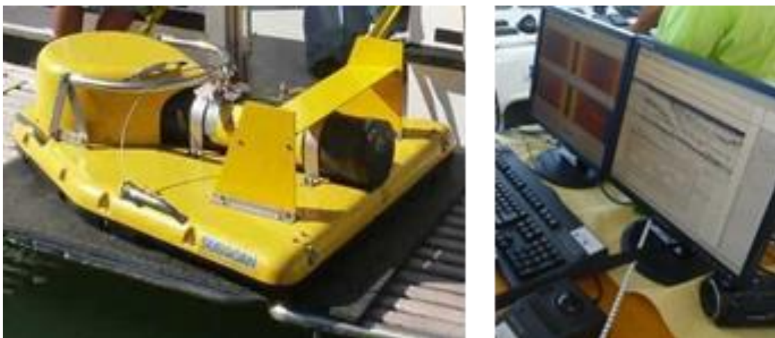
Figure IV.3: Sistema integrado Edgetech 512i, da Universidade de Aveiro, que combina um sonar de varrimento lateral de dupla frequência (100 e 400kHz), com um sistema de reflexão sísmica Chirp Sonar (0.5 e 12kHz).
