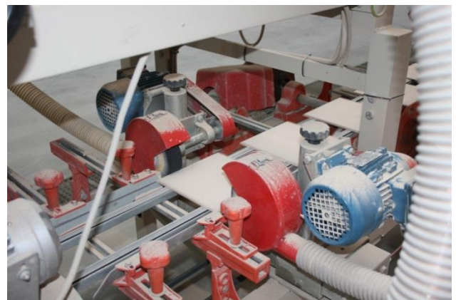
Figura 16 - Limpeza das arestas dos azulejos
