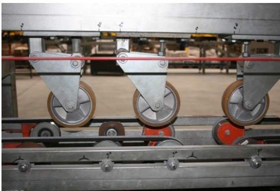
Figura 21 - Rolos de tensão
