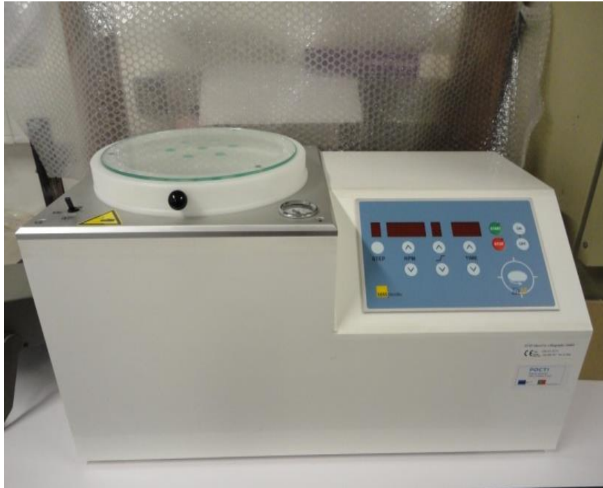
Figura 14: Spin coater Delta 10TT, usado para aplicar o composto no cristal.
