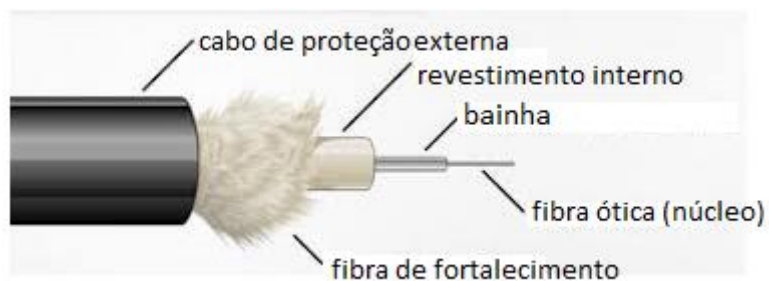
Figura 5: Estrutura de uma fibra ótica (adaptado de: www.tecmundo.com.br /imagens dia 13 de Julho de 2015).
