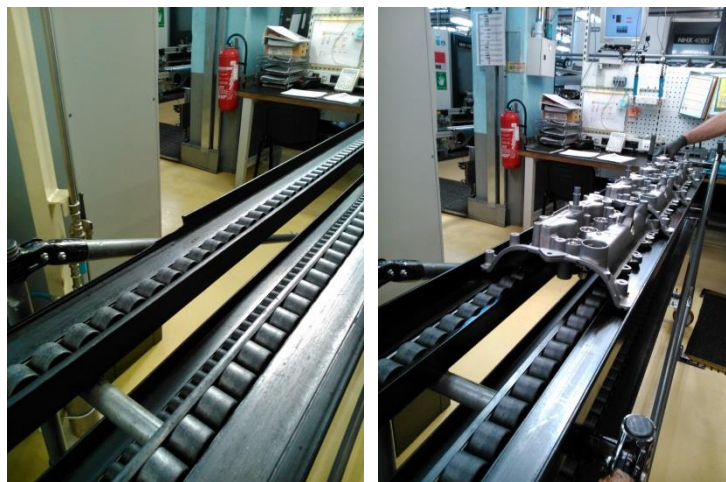
Figura 54 - Substituição de guias laterais na linha de montagem da Tampa da Culassa
