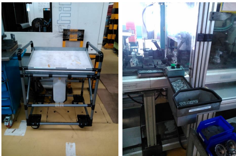
Figura 49 - Implementação de carrinho + reservatório + alimentador de molas
