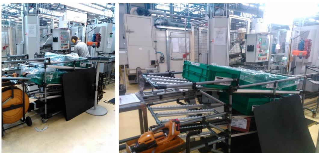
Figura 55 - Aumento da capacidade de abastecimento para 4 horas de autonomia na linha de montagem da Tampa da Culassa
