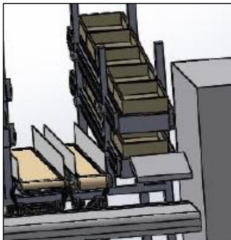
Figura 23 - Sistema de Abastecimento Automático (Crepine+Filtro+Monobloco)
