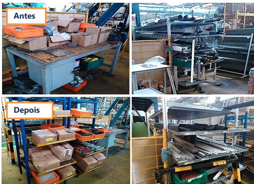
Figura 59 - Implementação dos 5S's na zona reservada à construção das estruturas para o projeto
