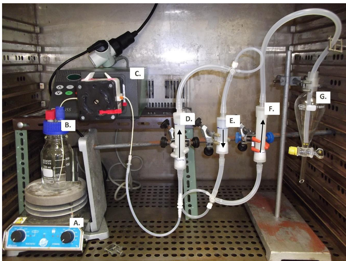
Legenda: A. Placa de agitação; B. Frasco da mistura reacional de alimentação do sistema; C. Bomba peristáltica; D. 1º biorreator de leito fixo; E. Coluna com a resina; F. 2º biorreator de leito fixo; G. Pontos de amostragem.
