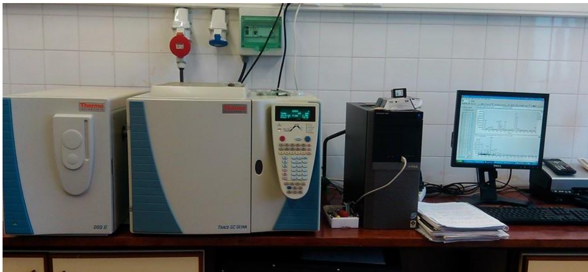
Figura 3.9. TRACE GC ULTRA acoplado a um espectrômetro de massa DSQ II, da Thermo Scientific.
