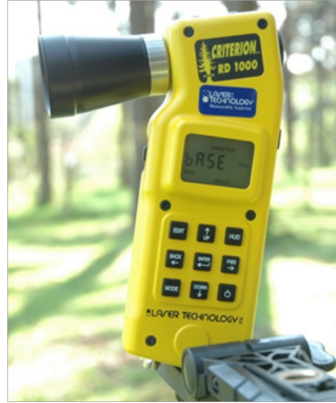
Figura 5. Mensagem "BASE", com o alerta para tomar a medida da base do ângulo até a árvore.
