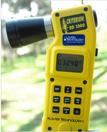
Figura 4. Entrada da distância entre o equipamento e a árvore, neste caso 32,40 m.
