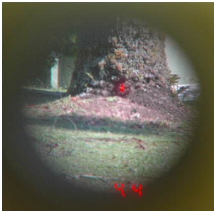
Figura 6. Medida da inclinação do terreno tomada na base da árvore, neste caso 4,4°.
