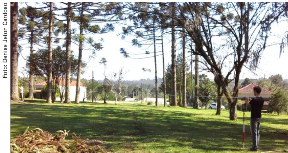
Figura 3. Medição da distância do equipamento até a árvore com trena.
