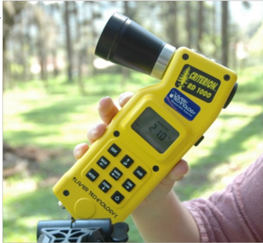
Figura 7. Medida de altura da árvore, no caso 21,0 m.
