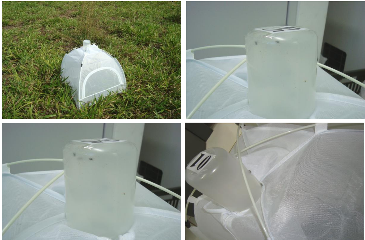
Figura 3. Gaiola de emergência Soil Emergence Trap (BioQuip Products, Inc., Cat. Number #2890) utilizada para a recuperação das moscas Haematobia irritans recém-emergidas.
