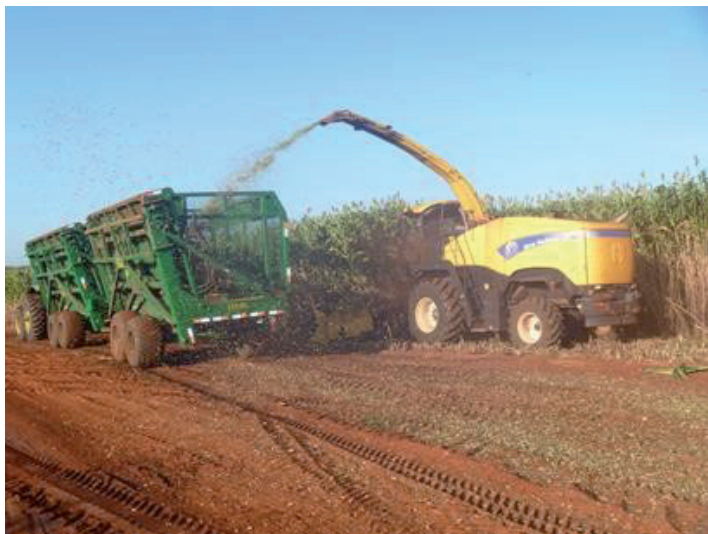
Figura 15. Vista da Carreta Transbordo, ao lado da Forrageira CNH FR9060, recebendo a carga de colmos picados. Usina Rio Vermelho, Dracena-SP. Foto: Evandro Chartuni Mantovani, 2015.
