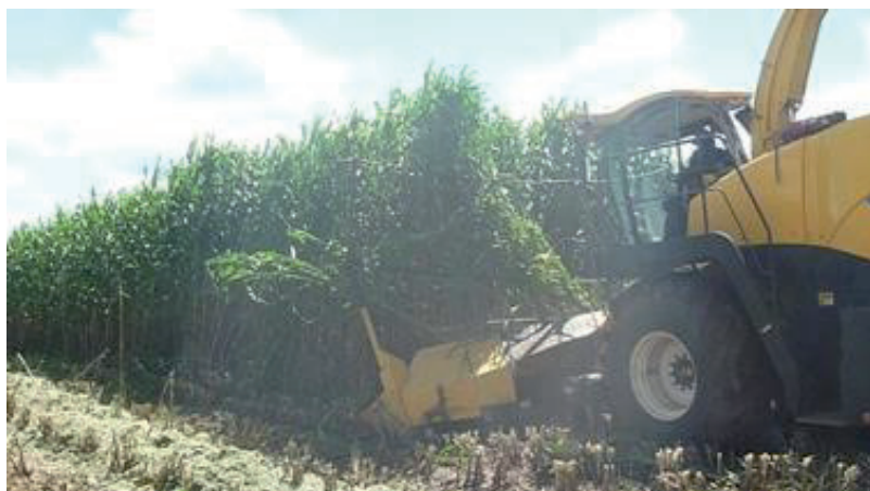
Figura 10. Vista da Frrageira CNH FR9060, colhendo com as modificações: anteparos e separadores de linha, na Embrapa Meio Ambiente, em Jaguariuna-SP, 2015. Foto: Evandro C. Mantovani.
