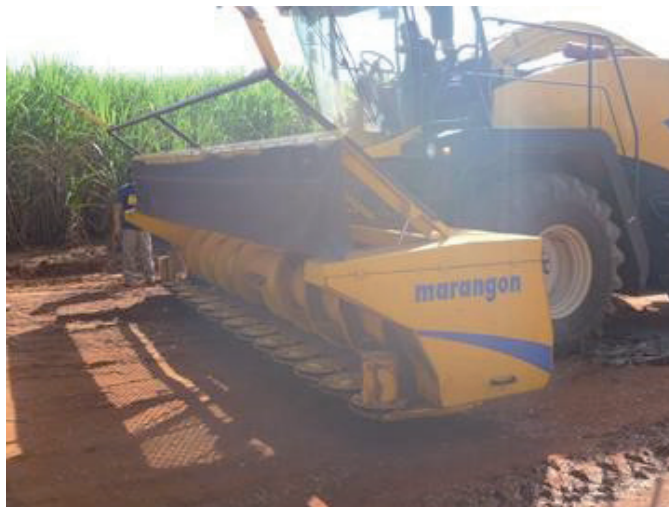
Figura 17. Vista da plataforma Marangon, acoplada à Forrageira New Holland CNH FR9060, na Usina Rio Veremelho, Dracena-SP, 2015. Foto: Evandro Chartuni Mantovani.
