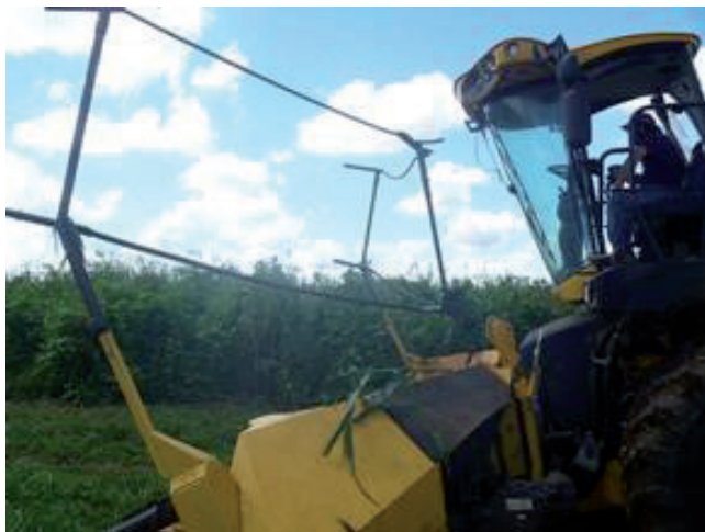
Figura 7. Detalhe dos anteparos colocados na plataforma Kemper para os testes de colheita, na Embrapa Meio Ambiente, em Jaguariuna-SP. Fotos: Evandro C. Mantovani, 2015.
