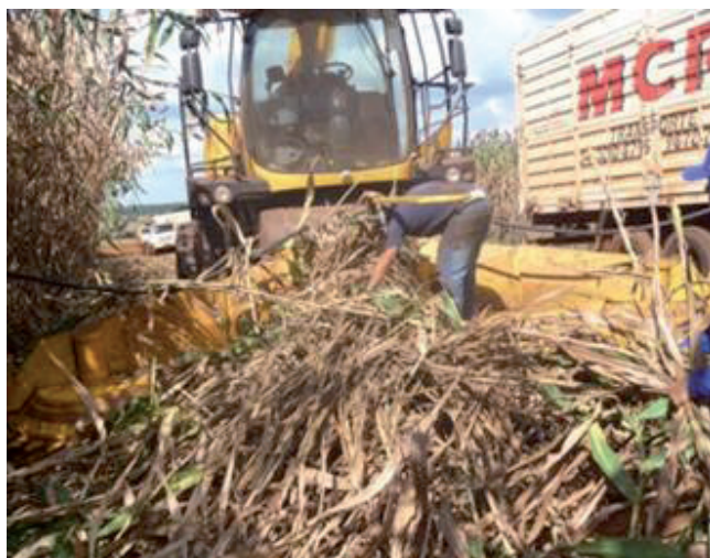
Figura 5. Ilustração do problema de acamamento da cultura durante a colheita mecânica que ocasionou paradas frequentes para desembuchar a plataforma de corte, na Usina Santa Vitória, em Santa Vitória-MG. 21 a 28/05/ 2014.
