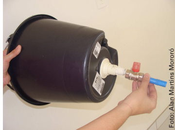
Figura 4. Montagem do balde para armazenamento da água clorada.
