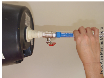
Figura 5. Montagem do balde para armazenamento da água clorada.
