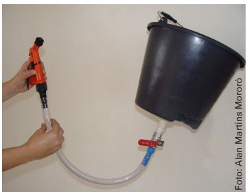
Figura 6. Montagem do balde para armazenamento da água clorada.
