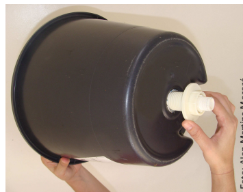
Figura 3. Montagem do balde para armazenamento da água clorada.
