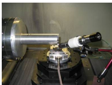
图 4.19 超精密飞刀加工的实验设置
