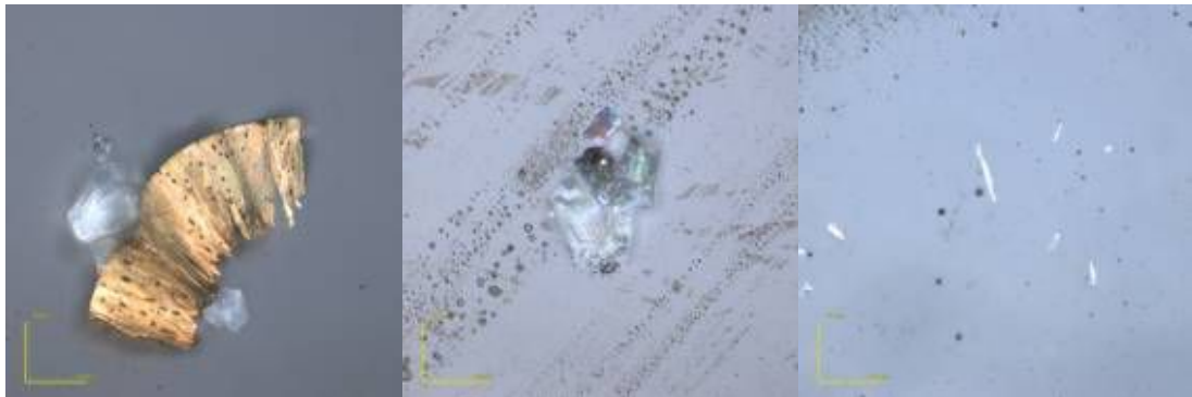
图 4.31 不同切削参数下对应的切屑：负前角(a)-15(b)-12(c)-8
