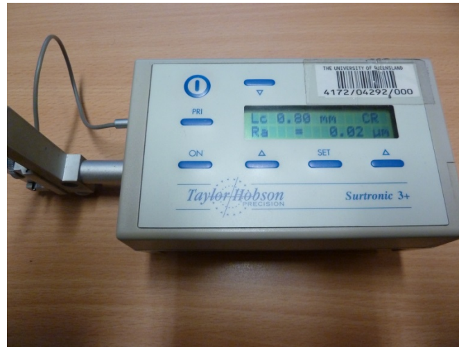
Fig.3.12. Taylor-Hobson Surtronic 3+ Profilometer.
