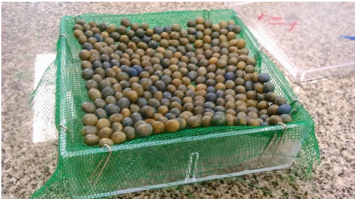
Figura 4: Caixas gerbox, compartimentos separados, superior semente de soja tratada, inferior com 40mL de água prontas para acondicionamento no germinado.
