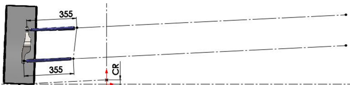
Figura 7 – Suspensão de braços inclinados e paralelos (Caso 2)
