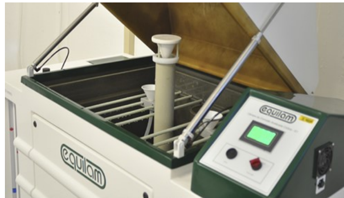
Figura 15 - Equipamento de Névoa Salina utilizada nos ensaios
