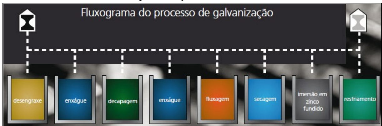
Figura 2 - Fluxograma esquemático dos banhos utilizados para um processo de galvanização com zinco
