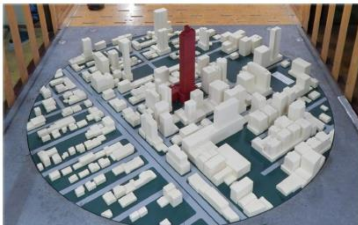
Figura 32 - Modelo do edifício 2 e vizinhança para análise em túnel de vento na escala 1:300
