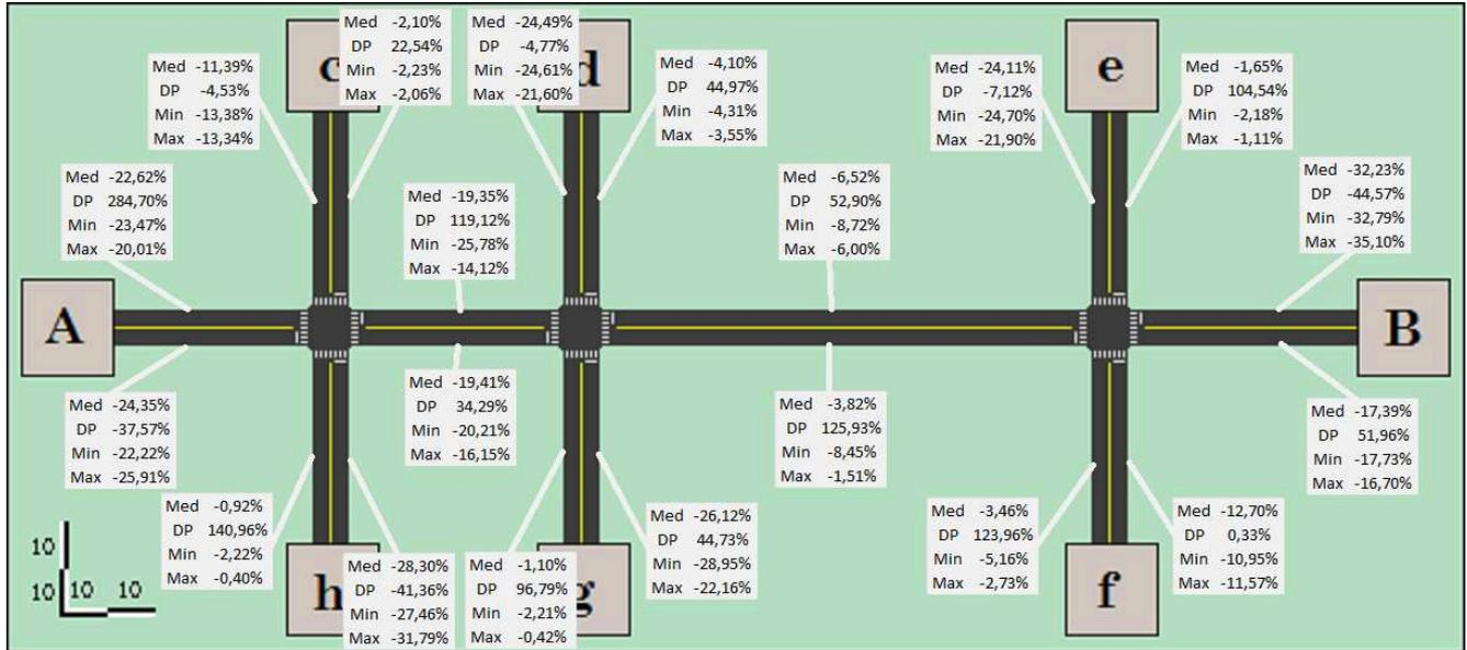
Figura 74: Diferença de atraso nas seções do modelo II ajustado semaforizado
