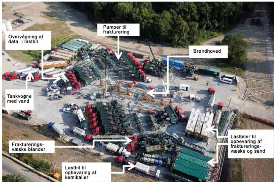
Billede 2. Fase 4. Hydraulisk frakturering. Eksempler på skiferborepladser i Marcellus formationen. Copyright: Kansas Geological Society.
