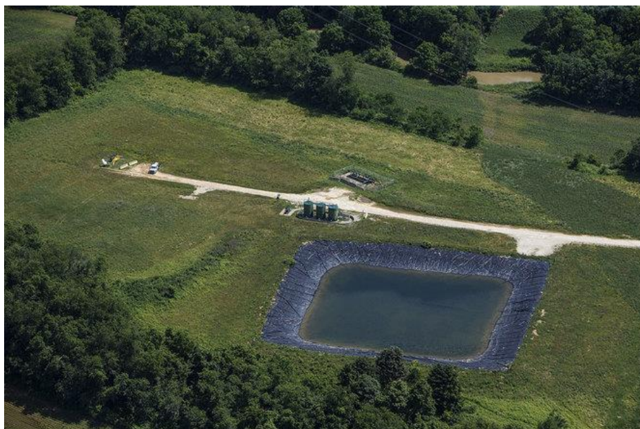
Billede 5. Gradvis tilbageføring til græsområde. Nedlukning af boreplads. Copyright: Dan Gleiter. Pennlive.
