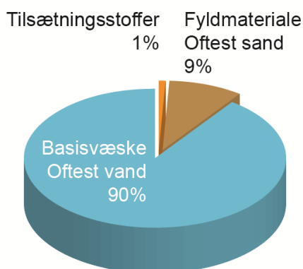
Figur 8 viser komponenterne, der udgør en fraktureringsvæske: En basisvæske, et fast granulært fyldstof, og en lang række tilsætningsstoffer med specifikke formål som korrosionsbeskyttelse, bakteriebekæmpelse med videre.
