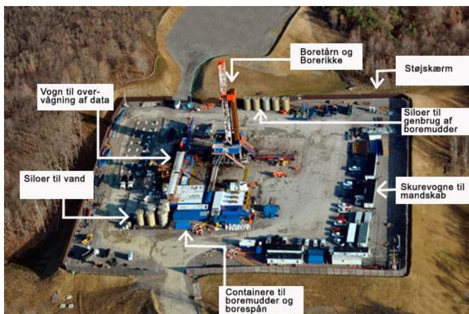
Billede 1. Fase 3. Horisontal boring. Eksempler på skiferborepladser i Marcellus formationen. Copyright: Maruellsus-Shale.US.
