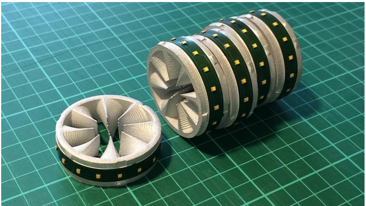
Seneste version (vers. 4) kølemner med manuelt monteret PCB
