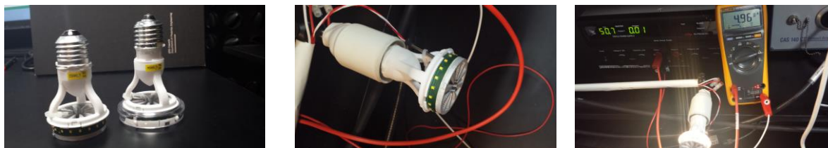
Fotos af de to CoolLED lyskilder som er blevet undersøgt for effektivitet og varmeudvikling på kølestrukturen.
