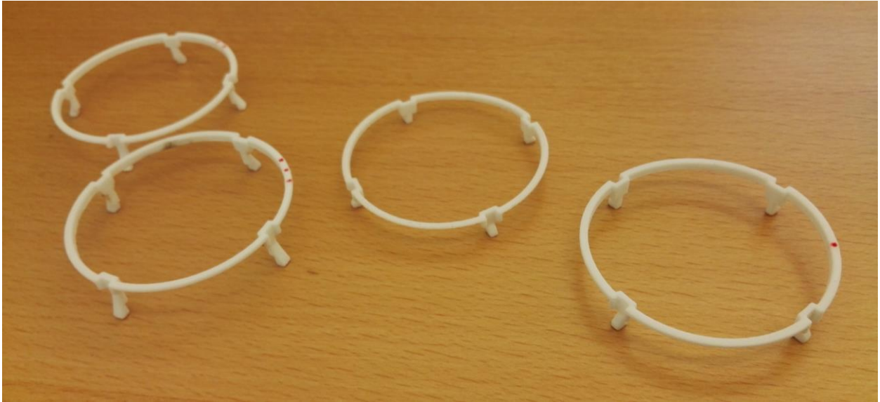
Eksempler på adapterringe udført i SLS
