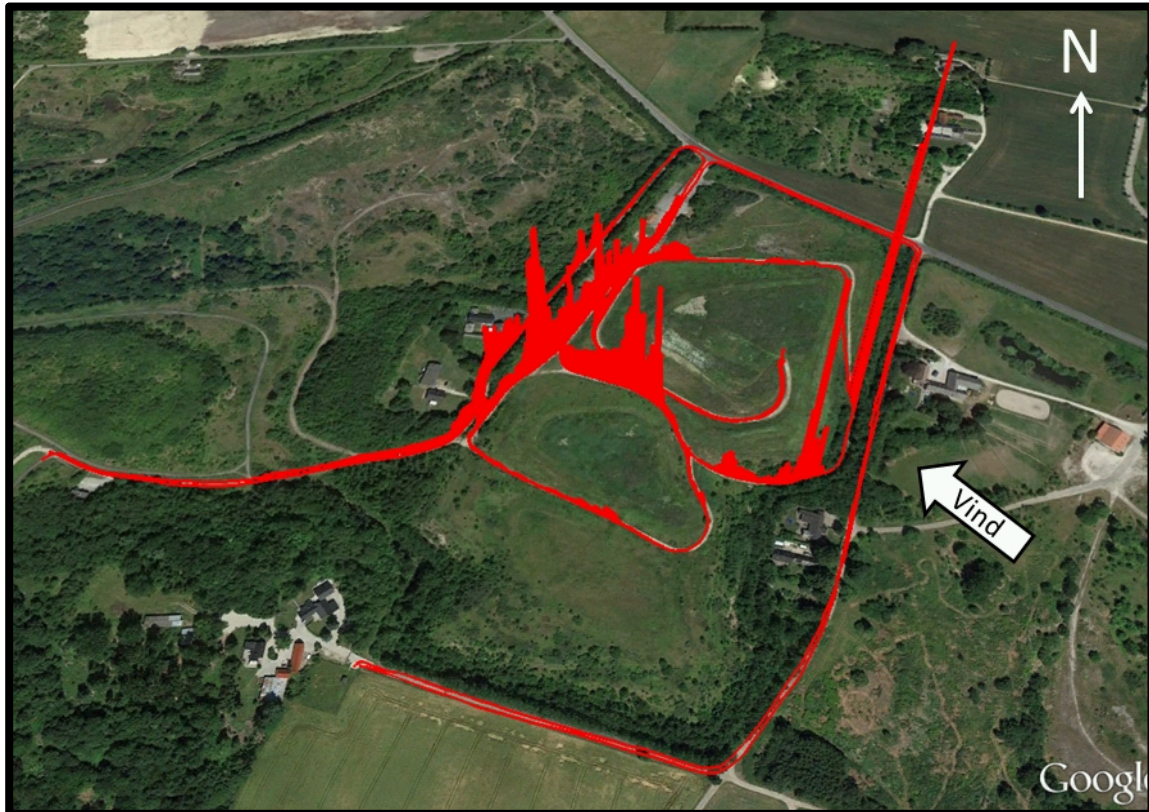
Figur 3. Metanscreening d. 21-05-2014 med fintfølende måleudstyr rundt på farbare veje på Hedeland deponi. Baggrundskoncentrationen af metan på 1920 ppb er fratrukket. Den højst målte metankoncentration er 6000 ppb over baggrund.
