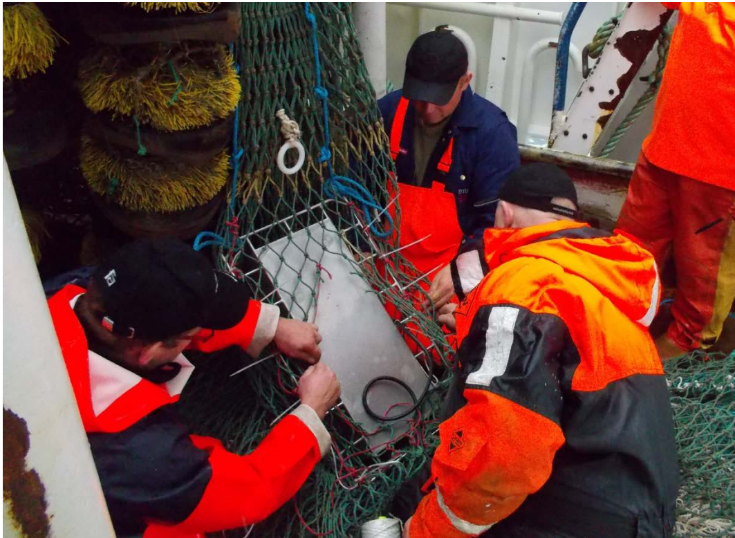
Figur. 4.6.1. Montering af kamerasystem til optagelser af underpladen.
