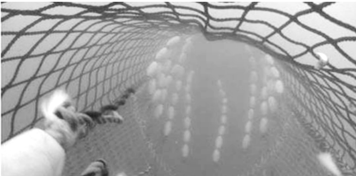
Figur 4.2.7.1. Billede af flydetov ved en slæbehastighed på 3 knob. Billedet er taget fra den forreste del af en BACOMA-fangstpose og peger bagud 19 .
