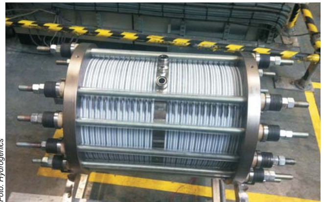
RESelyser alkalisk elektrolysestak på 10 kW.
