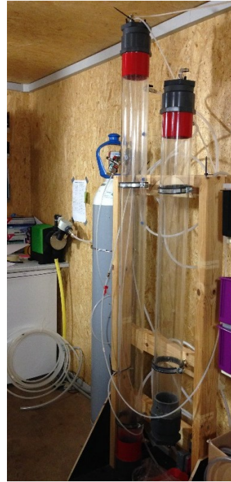
Figur 31 Gennemstrømningsopstilling til kontinuert ozonbehandling af udløbsvandet fra MBBR-systemet. Venstre: Skematisk tegning Højre: Foto af opstillingen placeret i containeren.
