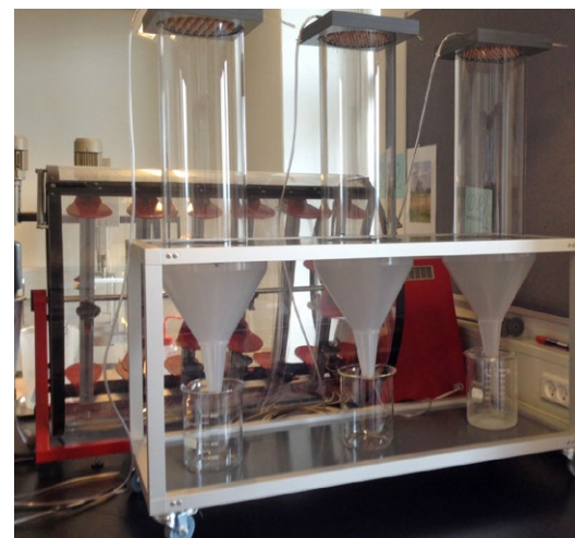
Opstilling af kolonner til test af ALCOsand iblandet filterjord i projektets tredje fase.
