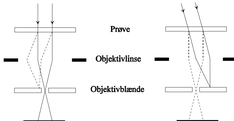
Figur 4.4.1 Skematisk tegning af billedannelse i TEM (a) lysfeltbillede og (b) mørkefeltbillede. Den direkte stråle er tegnet fuld optrukket og den diffrakterede stråle er stippet. I lysfelt billedet skæres man de diffrakterede stråler væk med objektivblænden. I mørkefelt billede afbilleder man med en diffrakteret stråle. Bemærk at man vipper den indkommende elektronstråle for at den diffrakterede stråle skal gå langs mikroskopets optiske akse.
