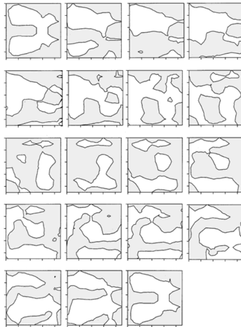
Figur 11.6.2 Eulerplot af forholdet mellem slipamplituden for det mest aktive slipsystem og for det næstmest aktive slipsystem beregnet ud fra en Tayloranalyse. Akser som Figur 11.3.1. Områder, hvor forholdet er højt, er hvide og områder, hvor forholdet er lavt, er grå. Kontouren som adskiller hvide og grå områder svarende til 50% hvid og 50% grå er 0.55.
