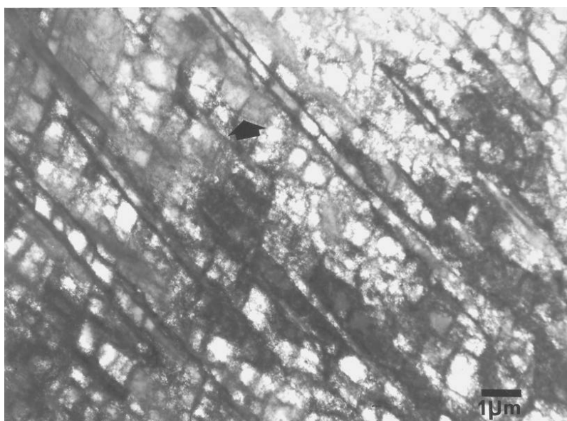
Figur 5.2.1 Cu IVa: Valsereduktion 28%, længdeplanet (valseretning indikeret med pil). Lange andengenerations mikrobånd i HWD-struktur. Bemærk at de nærmest “pløjer” sig igennem strukturen.
