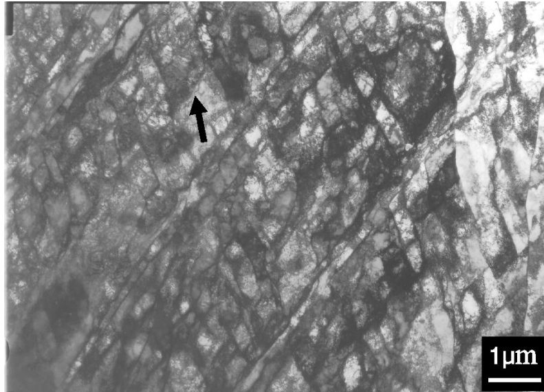
Figur 5.2.14(Cu IVa) Valsereduktion 65%, længdeplanet (valseretning indikeret med pil). Der eksisterer stadig lommer af noget der ligner HWD-strukturer. Men det er ikke længere muligt at skelne om kornene tidligere i deformationshistorien har været af LWD eller HWD-typen.
