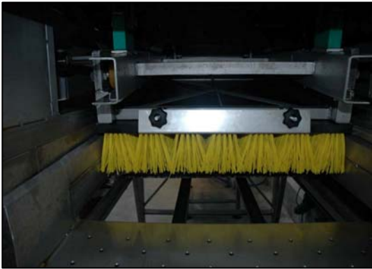
Figur 5.19. Viser den bevægelige overliggende ramme med koste.
