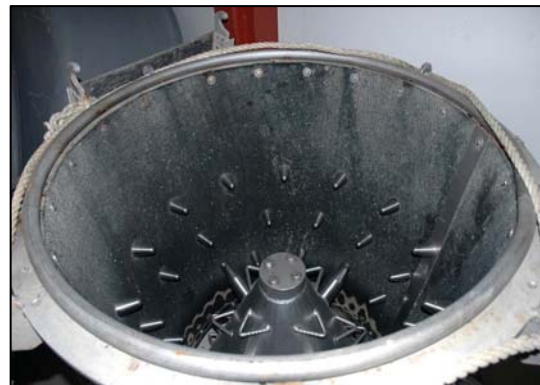
Figur 5.25. Viser kanten af den koniske afstripper hvor der er påmonteret en spray-ring der sørger for vandtilførslen til systemet.
