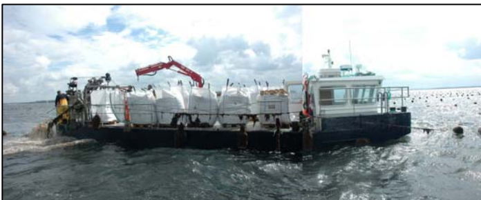
Figur 5.1. Lodberg og Co. A/S's høstbåd "Karin Buur". Venturisystemet ses påmonteret agter.
