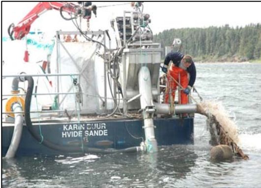
Figur 5.7. Afskæring af vækststov fra hovedlinen.
