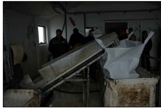
Figur 5.37. Transportbånd efter sortering i WiTho-maskinen
