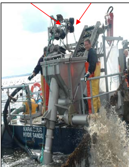
Figur 5.4. Viser de to fremføringsenheder til væksttov.
