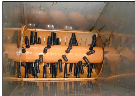
Figur 5.33. "Gummifingrene" der sorterer og fremfører muslingerne inde i kloakrøret.
