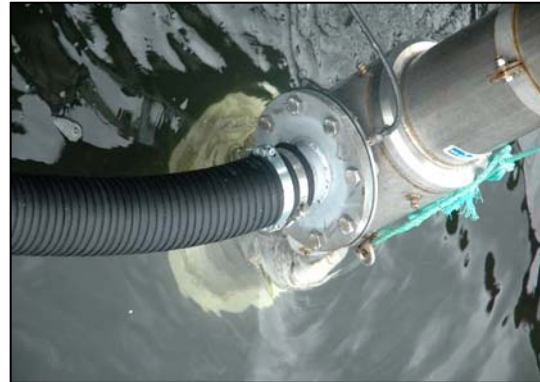
Figur 5.10. Indgang fra Desmipumpe til venturirør.
