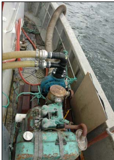
Figur 5.13. Viser 20 hk dieselmotor.
