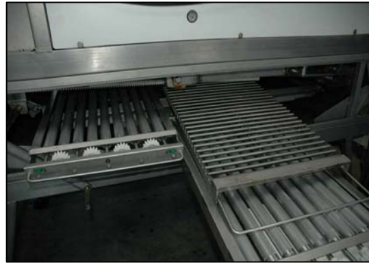
Figur 5.20. Viser de underliggende rammer; her vises både de roterende valser samt sorterristen.
