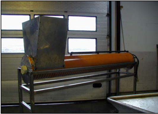
Figur 5.30. Den første prototype "kloakrørssorteren" udviklet hos Dansk Linemusling i Hvalpsund. Obs.: Denne prototype er uden declumper.
