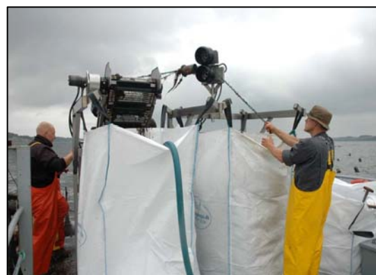
Figur 5.5. Inden fremføringsenhederne blev justeret var det nødvendigt at køre med manuel fremføring.
