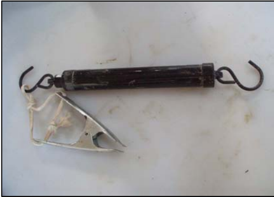
Figur 3.1. Viser fjedervægt med klemme som anvendes til måling af individuel trækstyrke.
