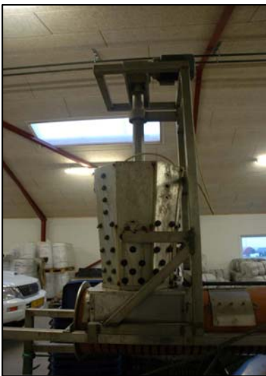
Figur 5.34. Horisontalt stillede declumper på kloakrøret
