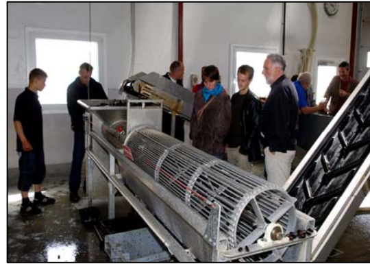
Figur 5.31. Eksempel på en mere traditionel sorteretromle. Denne type er fremstillet af aluminium og importeret fra PEI, Canada.
