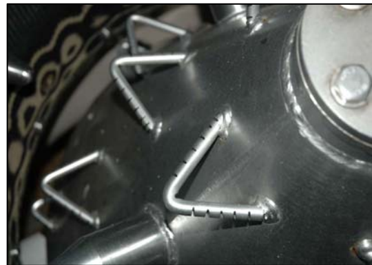
Figur 5.23. Viser de trekantformede slidsede "ører" der griber fat i strømpematerialet.
