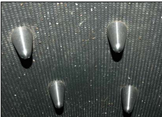
Figur 5.24. Viser "metalfingrene" der medvirker til at muslingerne strippes af strømperne.
