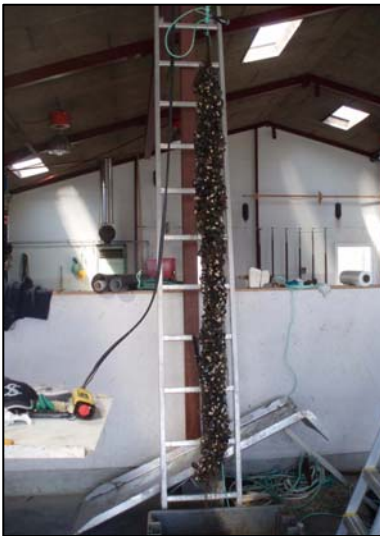
Figur 3.3. Ophængning af strømpe til ryk-test.
