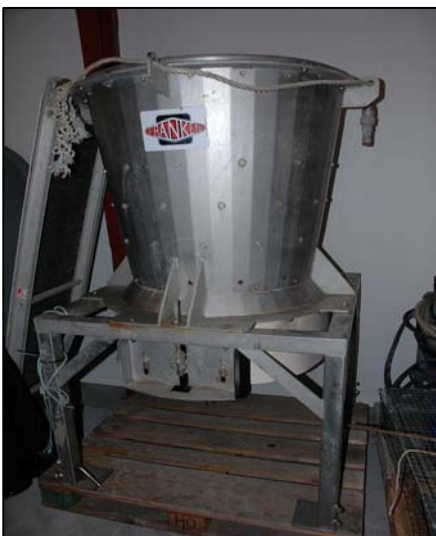
Figur 4D-5. Konisk afstripper fra Franken BV.
