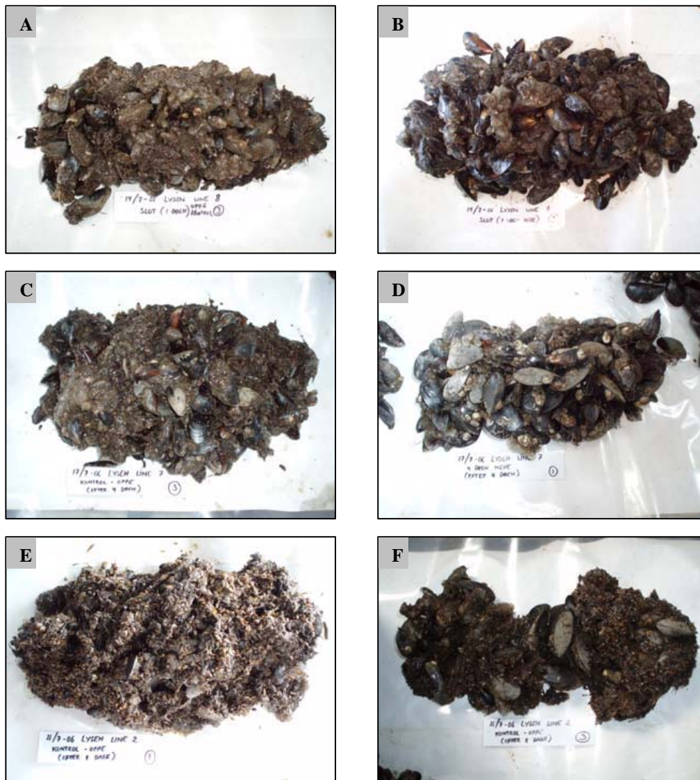
Figur 4B-7 A) kontrolstrømpen efter 1 døgns-forsøget. B) strømpen nedsænket 1 døgn. C) kontrolstrømpen efter 4 døgns-forsøget. D) strømpen nedsænket 4 døgn. E) kontrolstrømpen efter 8 døgns-forsøget. F) strømpen nedsænket 8 døgn på bunden
