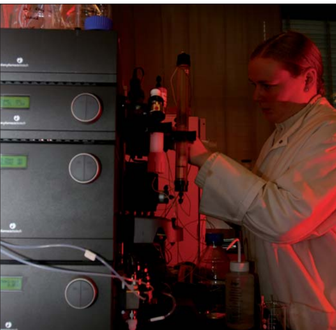
Kromatografisk oprensning af proteiner.
