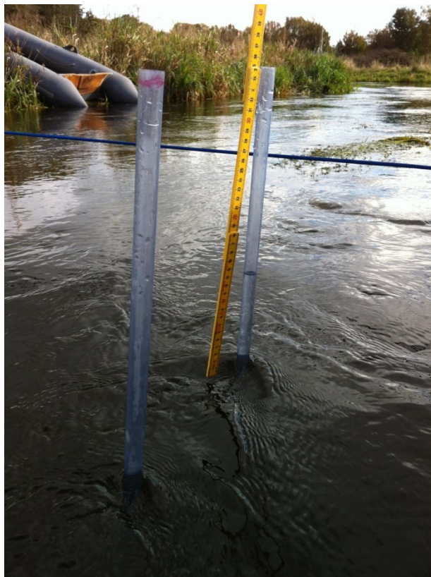
FIGUR 5.4 MÅLINGER AF TRYKFORSKEL MELLEM VANDLØB OG PIEZOMETER NEDSAT I ÅEN OG I GRUNDEVANDET UNDER ÅEN. FORDELEN VED AT BRUGE DE KLARE PLEXIGLASRØR OGSÅ FOR VANDLØBET ER, AT DET VED EN UROLIG VAND-OVERFLADE ER LETTERE AT BESTEMME VANDSPEJLET.
