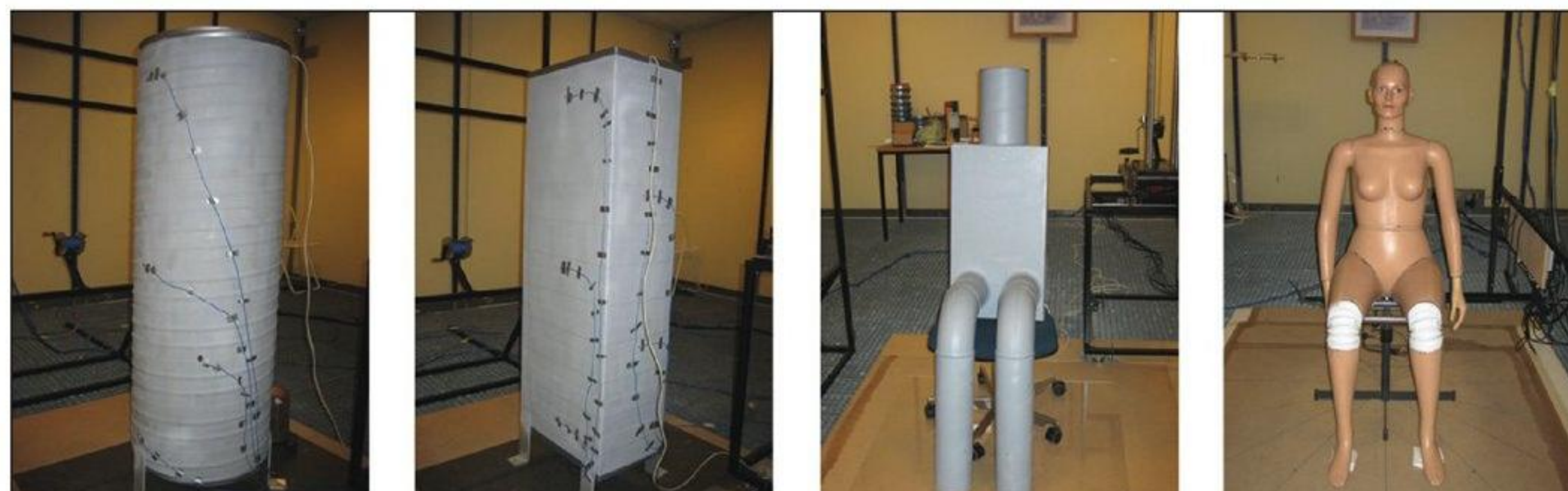
Figur 1. Personattrapper – cylinder, rektangulær kasse, dummy og termisk mannequin.
