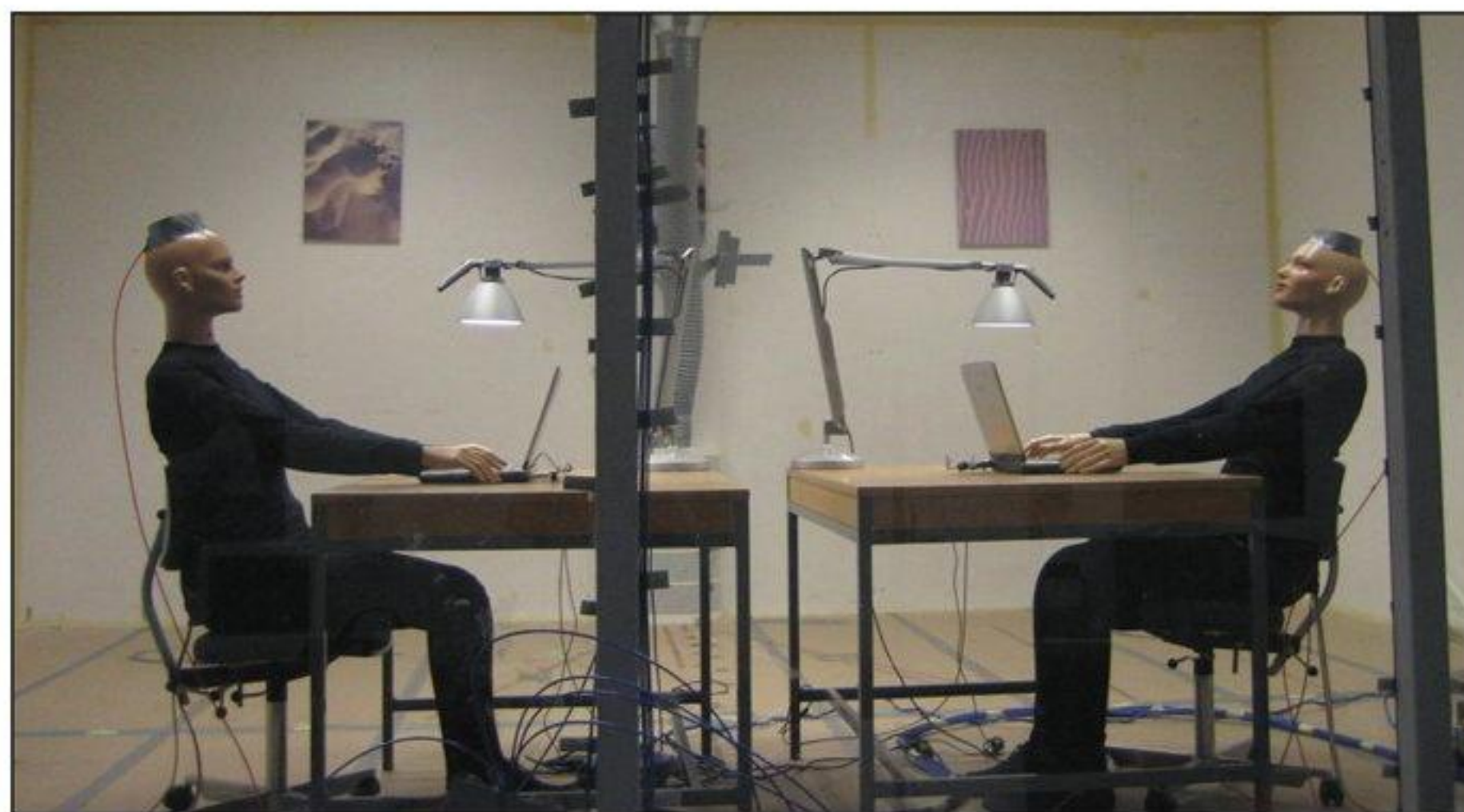
Figur 5. Forsøgsopstilling med to termiske mannequiner.
