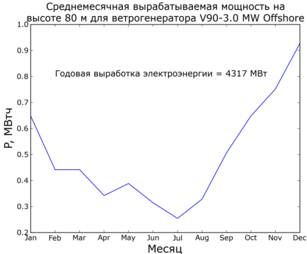
Рис 10. График среднемесячных значений мощности, рассчитанных для турбины V90-3.0 MW Offshore.
