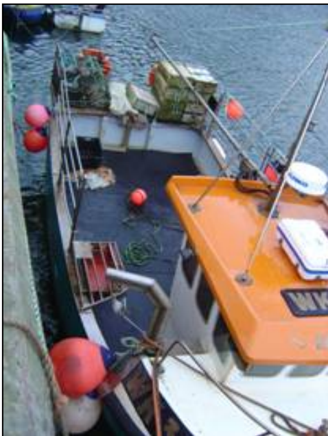
Fig. 4. Engelsk krabbefisker med frembygget styrhus og god dæksplads. Billedet er gengivet med tilladelse fra Christian Bollerup.
