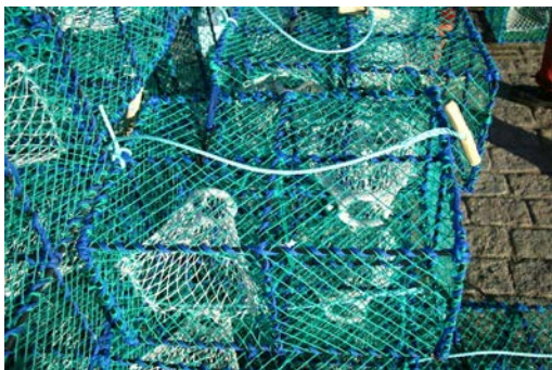
Fig. 6. Tejne af enkeltkammer-typen med fastbunden split. Træpinden stikkes gennem et splejset øje i tjavsens, og tejen er dermed nem at afmontere fra lænken, hvis linerne bliver viklet sammen.
