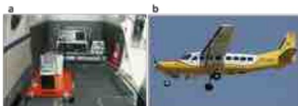
**Figura 3.** Instalación de los sensores CASI-550 y AISA Eagle II (a) en la aeronave Cessna Caravan B208 del ICGC (b).
