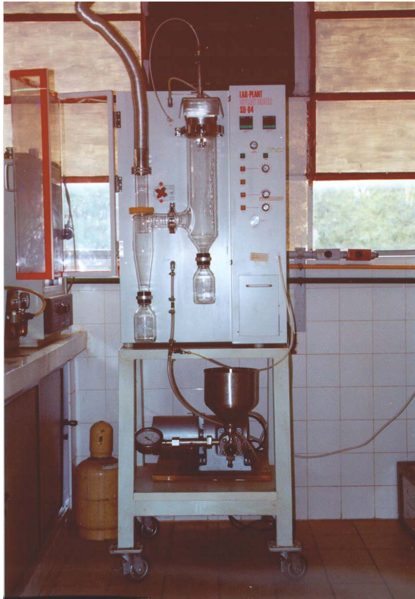
Figura 10 – Equipamento utilizado para a secagem por atomização do extrato de inulina de chicória
