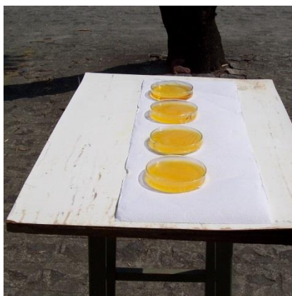
Figura 2. Exposição do corante Remazol Amarelo RNL 150% à radiação solar
