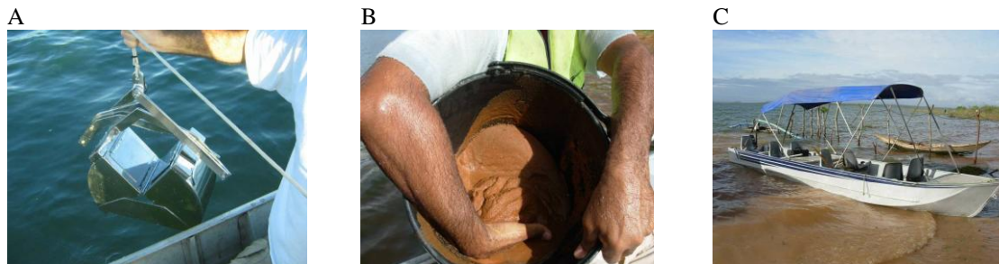
Figura 1 – Coleta de sedimentos: (A) draga modelo Petite Ponar e (B) homogeneização do sedimento dos pontos C,M,J e (C) Barco tipo voadeira, equipada com motores Yamaha de 25 e 40 HP. (CHESF, 2008).
