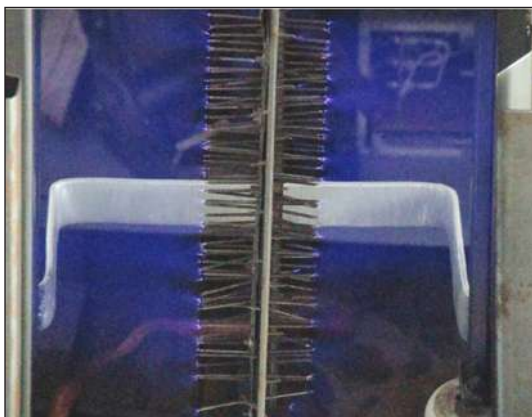
Рис. 3. Объемный разряд, реализуемый во всем объеме электродной системы
