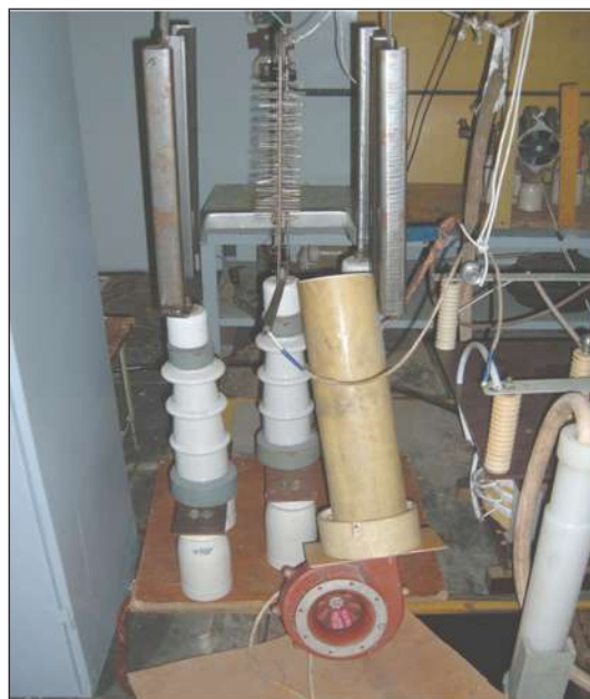
Рис. 4. Макет электродной системы с продувкой воздуха на остриях типа «щетка»
