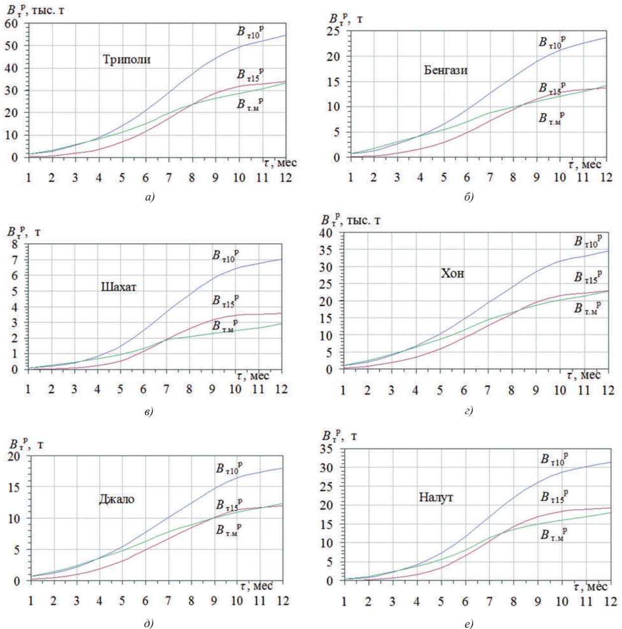
**Рис. 6.** Годовая экономия топлива  $B_T^P$  за счет охлаждения воздуха от текущей температуры наружного воздуха  $t_{нв}$  до  $t_{в2} = 10\text{ }^\circ\text{C}$  (ВАТТ или ЭТТ),  $t_{в2} = 15\text{ }^\circ\text{C}$  (АБТТ) и увлажнением воздуха до  $t_m$  на входе всех ГТУ электростанций 6 регионов за 2009 г.:
