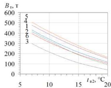
**Рис. 4.** Значения годовой экономии топлива  $V_T$  одной ГТУ номинальной мощностью 10 МВт при разных конечных температурах  $t_{B2}$  охлажденного воздуха для регионов Ливии, в которых расположены газотурбинные ЭС, за 2009 г.: 1 — Триполи; 2 — Бенгази; 3 — Шахат (восток); 4 — Хон (центр); 5 — Джало (юг); 6 — Налут (запад)
