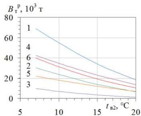
**Рис. 5.** Значения годовой экономии топлива  $V_T^p$  за счет охлаждения воздуха на входе всех ГТУ электростанций для 6 регионов при конечных температурах  $t_{B2}$  охлажденного воздуха (разных способах охлаждения) за 2009 г.:
