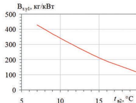
**Рис. 1.** Значения удельной (на 1 кВт мощности ГТУ) экономии топлива  $V_{\text{т,г1}}$  за год в результате охлаждения воздуха на входе ГТУ до разных конечных температур  $t_{\text{в2}}$  (г. Триполи, 2009 г.)
