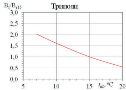
**Рис. 3.** Значения годовой экономии топлива в результате охлаждения воздуха на входе ГТУ до разных температур  $t_{B2}$  в относительном виде  $V_T/V_{T15}$  (г. Триполи, 2009 г.):
