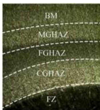
Рисунок 5 – Макроструктура зоны термического влияния лазерного сварного шва [12]
