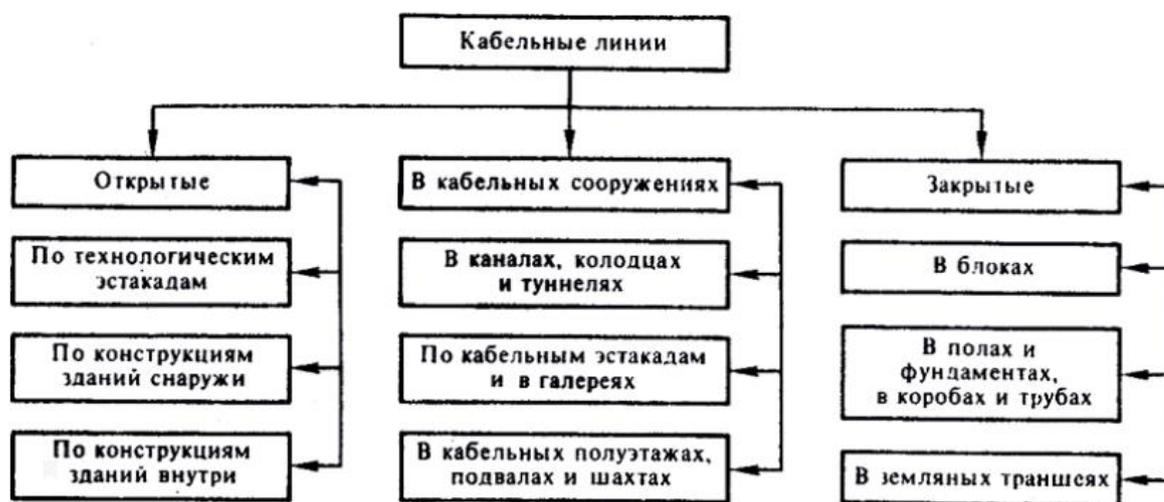
Рисунок 2 – Классификация кабельных линий по конструктивным признакам
