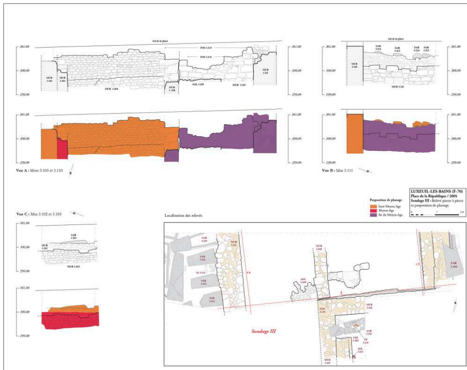
Fig. 1 – Relevés pierre à pierre des élévations du chœur et proposition de phasage
