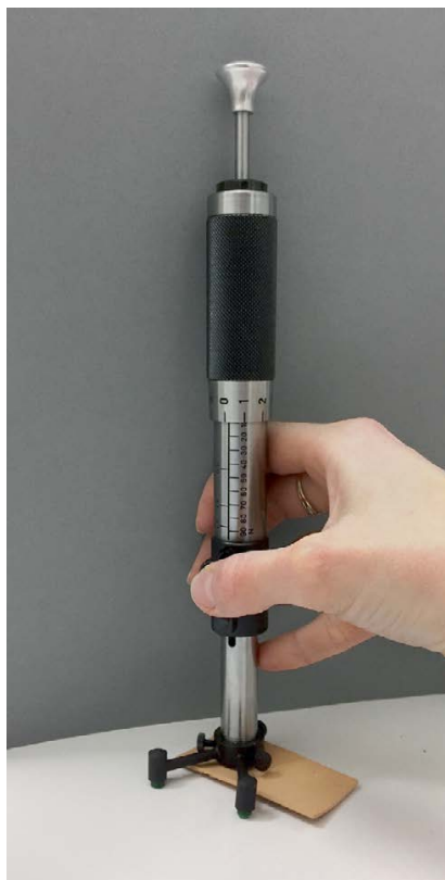
Fig. 1. Impactomètre à bille et éprouvette. © L. Rocourt.
