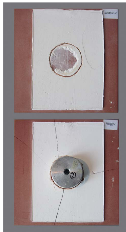
Fig. 5. Éprouvettes de Modostuc et de Flügger après le test d'adhérence. © L. Rocourt.
