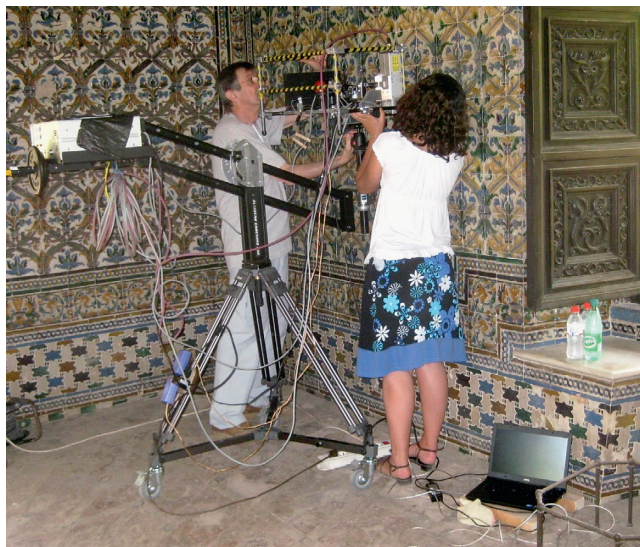
Fig. 4. FRX-DRX sur un support mobile pour l'analyse d'œuvre de grande dimension : par exemple, les murs couverts de carreaux en céramique de l'Alcazar de Séville. © Marie-Françoise Castaing.
