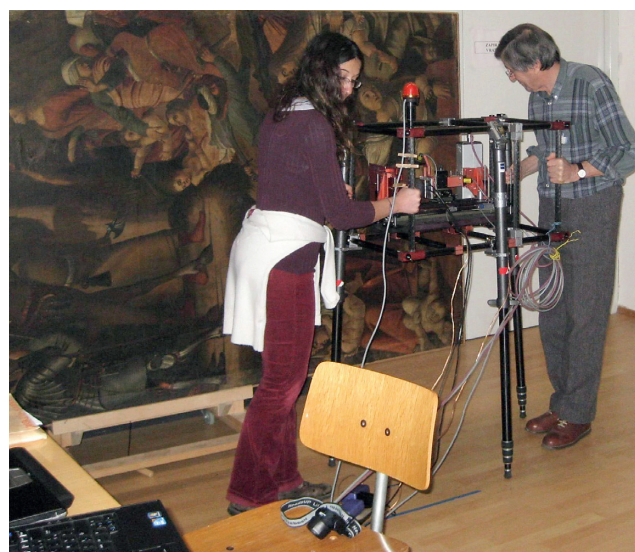
Fig. 3. FRX-DRX sur un support équipé de trois pieds télescopiques permettant une grande variation en hauteur (analyses entre 25 cm et 260 cm du sol). © Marie-Françoise Castaing.
