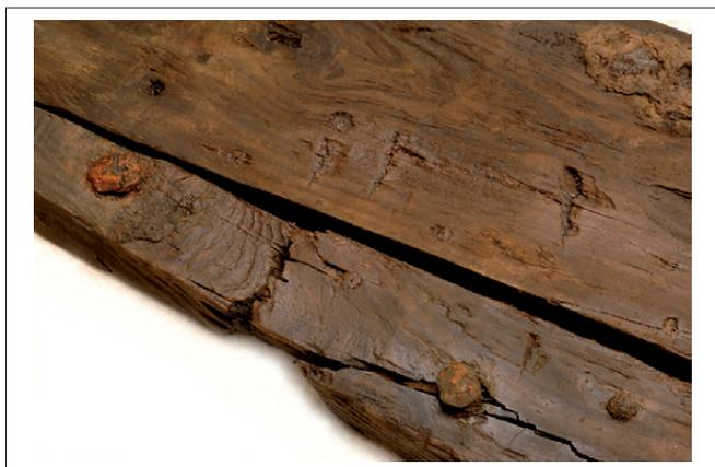
Fig. 243. Détail de la tête de deux clous en fer, utilisés pour fixer le bordage MR1264-56 à la membrure (cl. Chr. Durand - CCJ).
