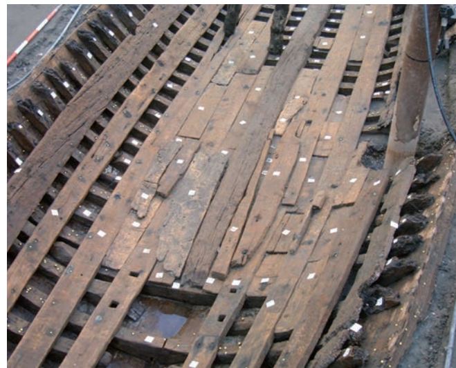
Fig. 12 : Les planches posées sur le vaigrage de part et d'autre de la carlingue/emplanture du mât vues depuis l'arrière du bateau (cliché G. Boetto).
