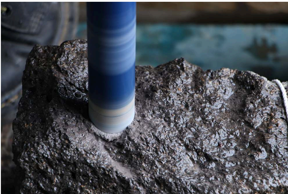
Fig. 2 – Meule en basalte en cours de carottage (Nogent-le-Roi, Eure-et-Loir)
